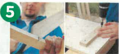
Für das Dach: Tiefe des Innenraums ausmessen, die Dachlatten entspre- chend kürzen und auf das vorher ausgesägte Dach mit den 4 kürzeren Schrauben montieren
